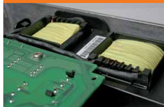
Les selfs DC réduisent les harmoniques et protègent le variateur
