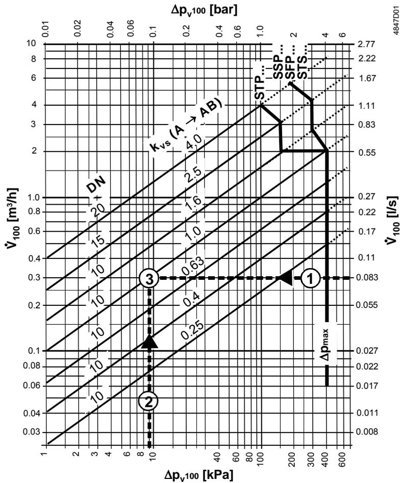
$\Delta p_{v100}$  = Différence de pression au travers du passage A → AB, pour une vanne entièrement ouverte et un débit volumique  $\dot{V}_{100}$
