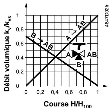
Les valeurs  $k_{vs}$  dans le bypass B n'ont, pour les vannes de types VXP47... / VMP47... que 70 % de la valeur  $k_{vs}$  dans le passage droit A → AB.
